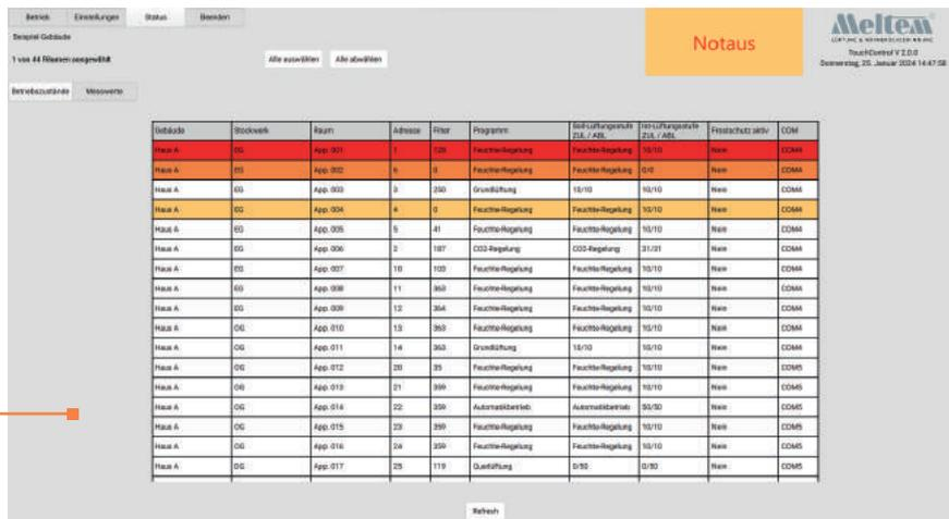
Die Meltem Touch Control Software kann schnell und einfach an verschiedene Einsatzfälle angepasst werden, eine grafische Darstellung der Raumanordnung erleichtert Übersicht und Bedienung.
