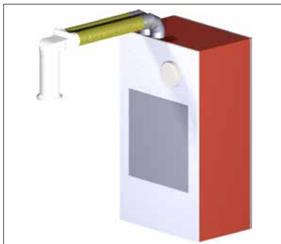
Abb. 5: Wandintegrierte Montage U 2 mit Kanalanschluss
