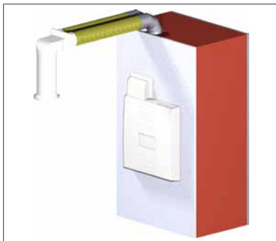
Abb. 4: Unterputzmontage mit Kanalanschluss
