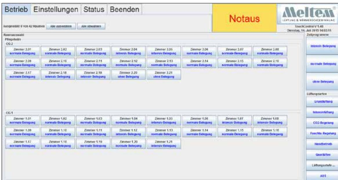
Abb. 10: Bedienoberfläche der Software Meltem Touch Control
