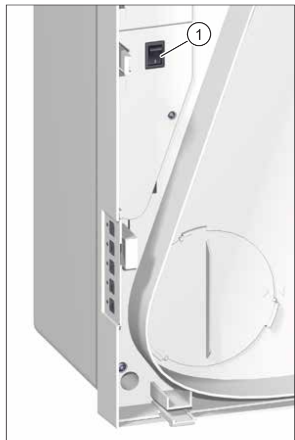
Abb. 14: Netzschalter, sichtbar nach Abnahme des Gerätedeckels
