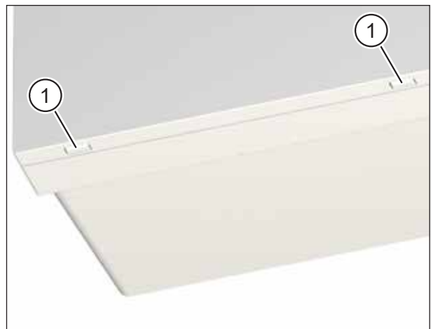
Abb. 22: Gerätedeckel vom Lüftungsgerät abnehmen
