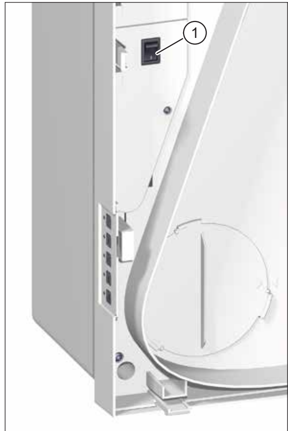
Abb. 11: Netzschalter, sichtbar nach Abnahme des Gerätedeckels
