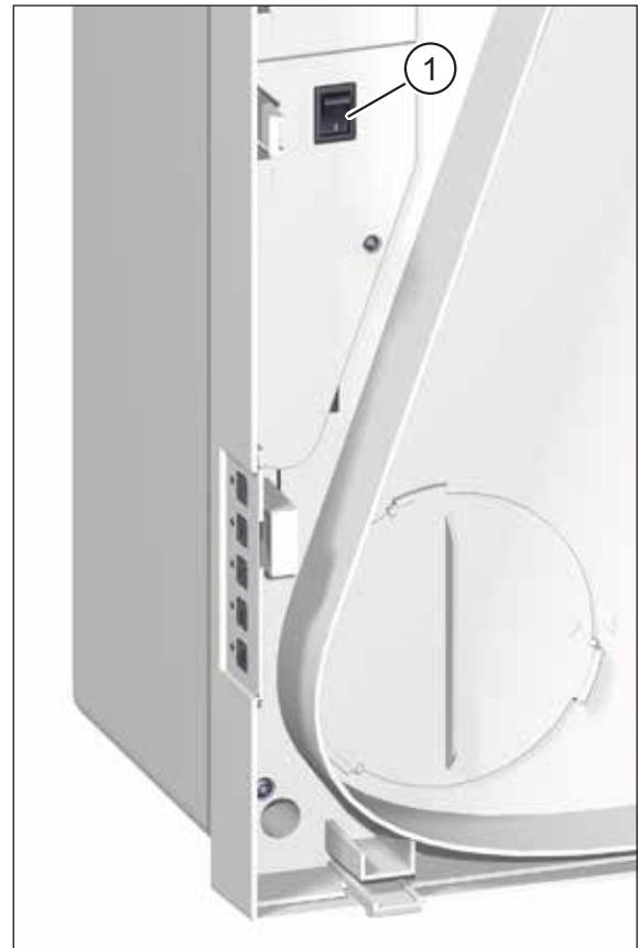
Abb. 9: Netzschalter, sichtbar nach Abnahme des Gerätedeckels
