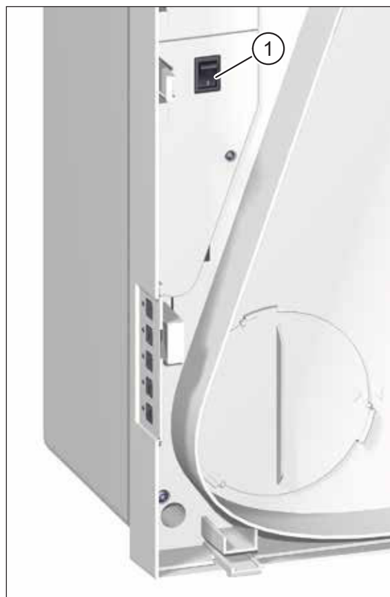
Abb. 18: Netzschalter, sichtbar nach Abnahme des Gerätedeckels
