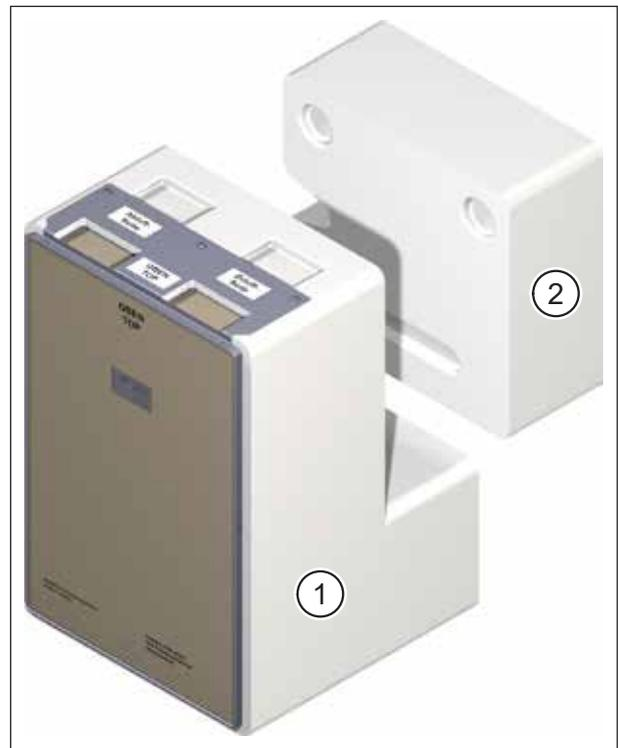
Abb. 1: Montageset M-WRG-II M-U<sup>2</sup> und optionales Füllstück M-WRG-II M/Fü
