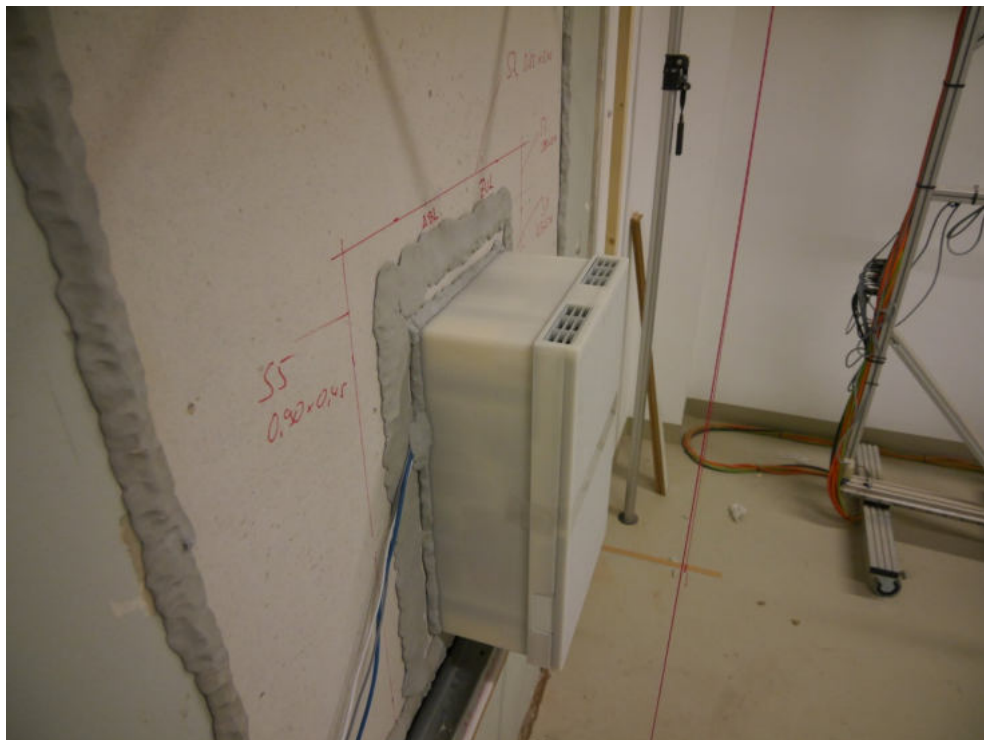
Abbildung B.10. Ansicht Lüftungsgerät innenseitig, prüffertig im Fensterprüfstand montiert und abgedichtet, Seitenansicht von schräg oben mit Lüftungsöffnungen (ABL vorne, ZUL hinten).
