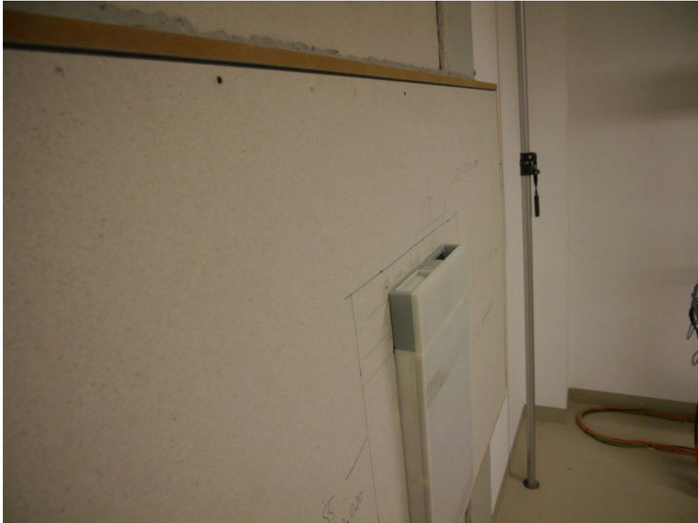
Abbildung B.19. UP-Einbau mit Kanalanschluss ABL-seitig prüffertig im Fensterprüfstand montiert und abgedichtet, Ansicht empfangsraumseitig von schräg oben.
