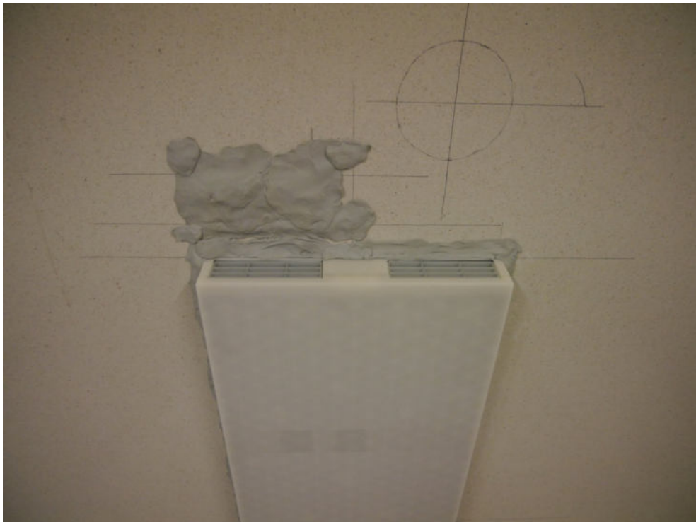
Abbildung B.14. UP-Einbau (Ein-Raum-Variante) prüffertig im Fensterprüfstand montiert und abgedichtet, Ansicht empfangsraumseitig von schräg oben mit Lüftungsöffnungen (ABL links, ZUL rechts).
