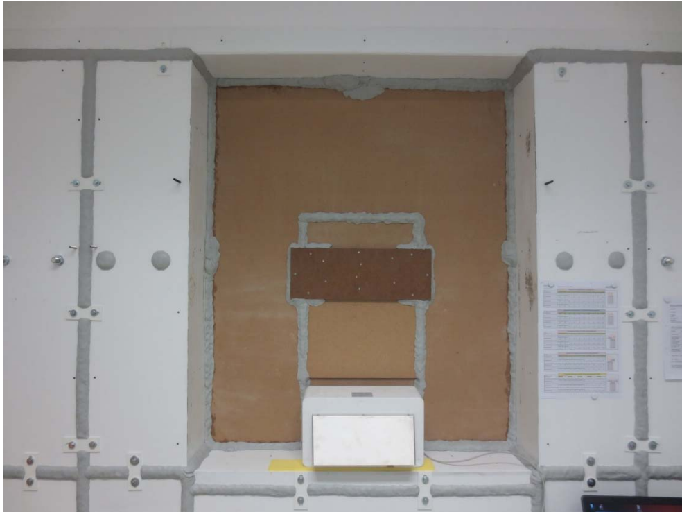
Abbildung B.5. Gesamtansicht Außenseite (prüffertig): Prüföffnung mit Trockenbaublende verschlossen, Fassadenabschluss Edelstahlschote auf Rohrträger (EPS) montiert.
