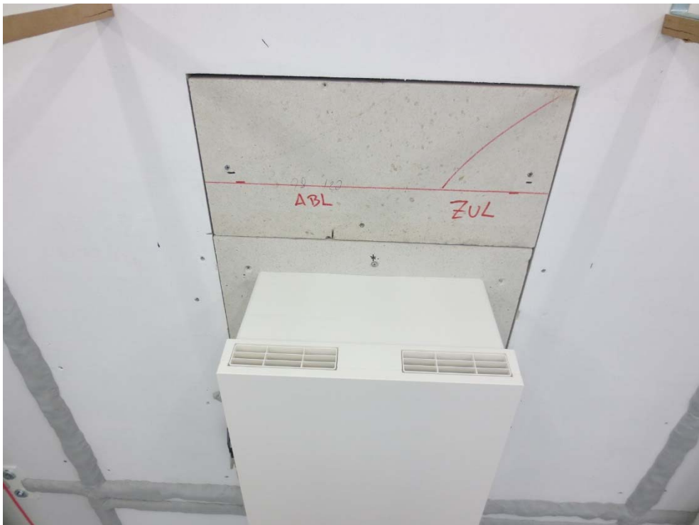
Abbildung B.8. Ansicht Innenseite von schräg oben mit Lüftungsöffnungen ABL links und ZUL rechts (prüffertig).
