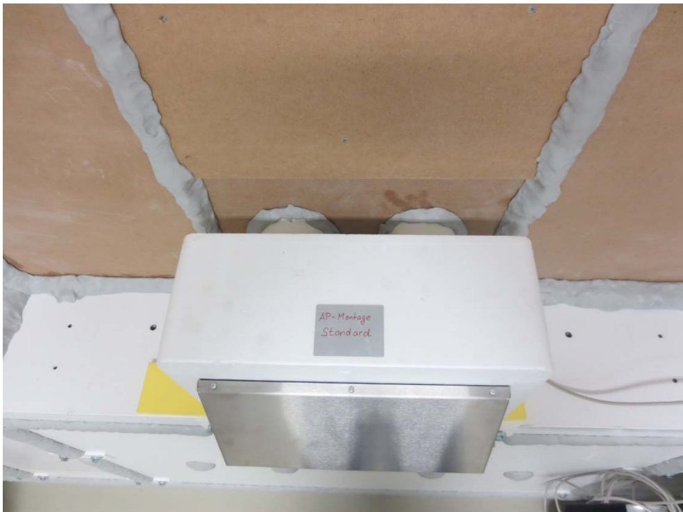
Abbildung B.2. Ansicht Außenseite von schräg oben (prüffertig): Fassadenabschluss Edelstahlschote auf Rohrträger (EPS) montiert.
