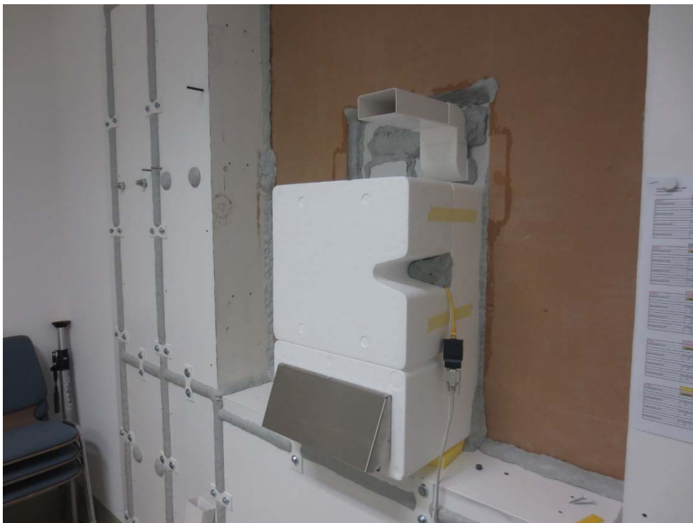
Abbildung E.4. Mehr-Raum-Variante mit Kanalanschluss ABL-seitig: Ansicht Außenseite (prüffertig). Kanalanschluss ABL nach außen (Senderraum) geführt.
