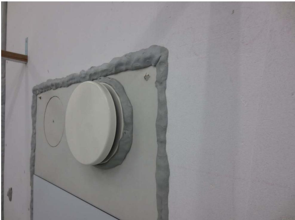
Abbildung D.10. Prüfvariante mit Kanalanschluss ABL-seitig: Ansicht Innenseite oben mit ZUL-Öffnung (prüffertig).
