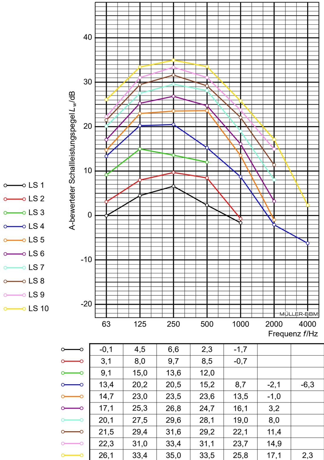
Abbildung C.2. Prüfergebnisse Lüftungsgerät der Serie M-WRG-II, Baureihe M-WRG-II E, Wandintegrierter Einbau (U<sup>2</sup>) mit Kanalanschluss ABL- und ZUL-seitig: Schalleistungspegel in Oktaven.
