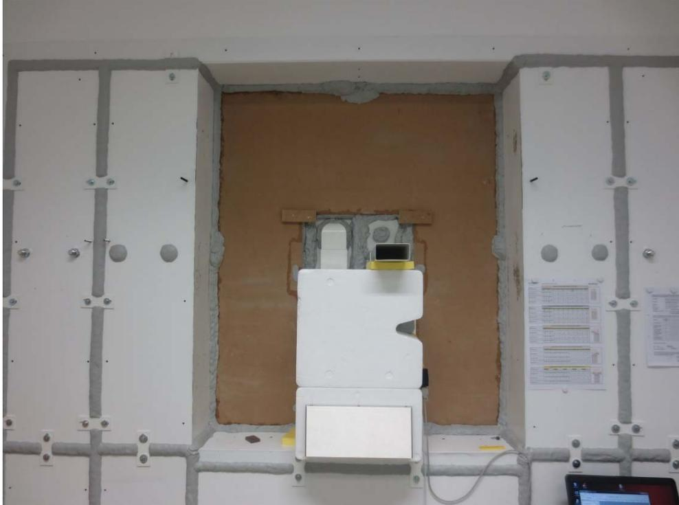
Abbildung D.5. Prüfvariante mit Kanalanschluss ABL-seitig: Frontalansicht Außen-seite (prüffertig). Kanalanschluss ABL nach außen (Senderraum) geführt.
