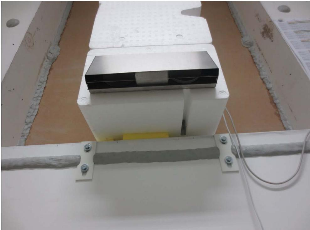
Abbildung D.4. Ansicht Außenseite von schräg unten (prüffertig): Fassadenabschluss Edelstahlsschote auf Mauerkasten montiert mit Außenöffnungen (FOL links, AUL rechts).
