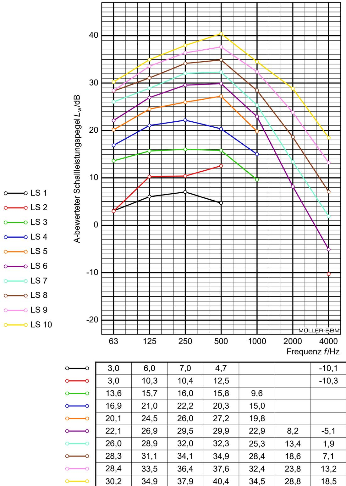
Abbildung B.2. Prüfergebnisse Lüftungsgerät der Serie M-WRG-II, Baureihe M-WRG-II E, Wandintegrierter Einbau (U<sup>2</sup>) mit Kanalanschluss ZUL-seitig: Schalleistungspegel in Oktaven.
