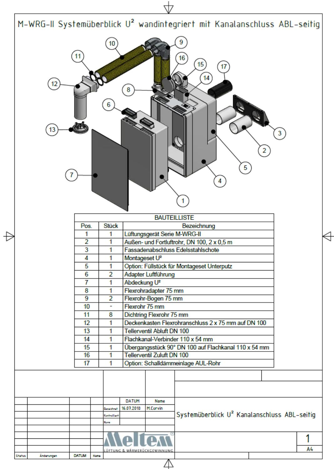
Abbildung E.8. U<sup>2</sup>-Einbau mit Kanalanschluss: Explosionszeichnung (Prinzipdarstellung für Kanalanschluss ABL-seitig, Anschluss über Flexrohre im Prüfaufbau geändert ausgeführt).
