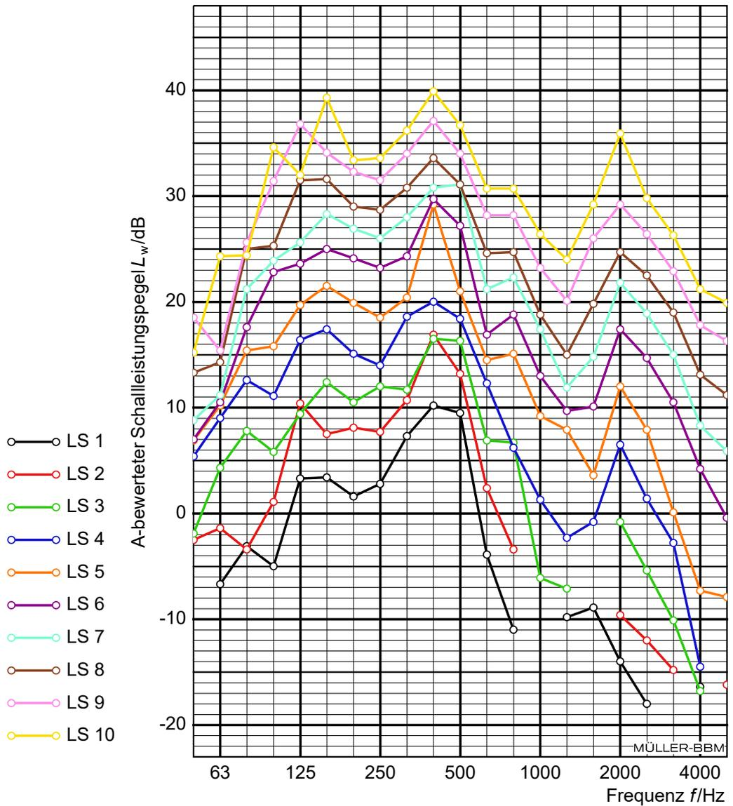
Abbildung A.1. Prüfergebnisse Lüftungsgerät der Serie M-WRG-II, Baureihe M-WRG-II E, Wandintegrierter Einbau (U<sup>2</sup>) mit Kanalanschluss ABL-seitig: Schallleistungspegel in Terzen.
