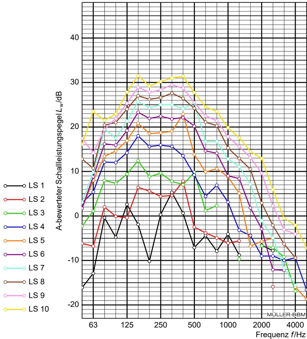
Abbildung C.1. Prüfergebnisse Lüftungsgerät der Serie M-WRG-II, Baureihe M-WRG-II E, Wandintegrierter Einbau (U<sup>2</sup>) mit Kanalanschluss ABL- und ZUL-seitig: Schalleistungspegel in Terzen.
