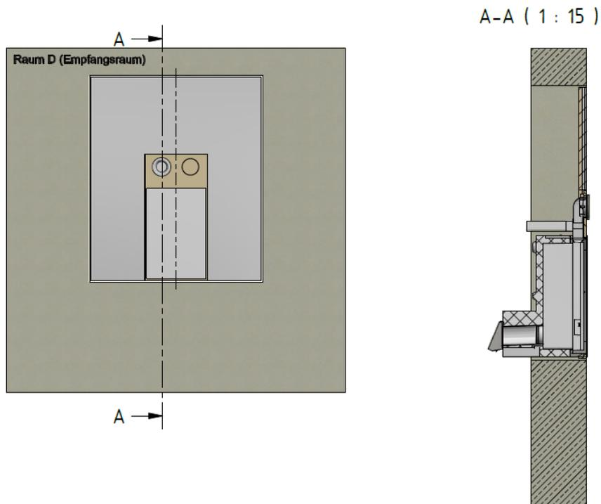
Abbildung E.5. Prüfvariante mit Kanalanschluss ZUL-seitig: Innenansicht und Vertikalschnitt des Prüfaufbaus.
