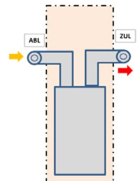
Für alle Prüfungen wurde der Standardfassadenabschluss verwendet, d. h. Fortluft FOL und Außenluft AUL werden über jeweils ein Kunststoffrohr DN 100 vom Gerät aus direkt nach außen geführt und sind auf der Außenwand mit einer Edelstahlschote abgedeckt.
