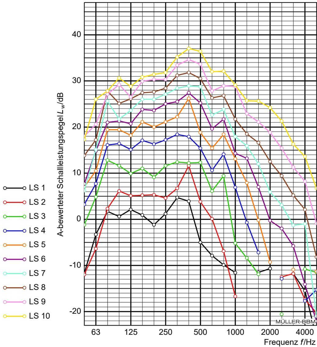
Abbildung B.1. Prüfergebnisse Lüftungsgerät der Serie M-WRG-II, Baureihe M-WRG-II E, Wandintegrierter Einbau (U<sup>2</sup>) mit Kanalanschluss ZUL-seitig: Schalleistungspegel in Terzen.
