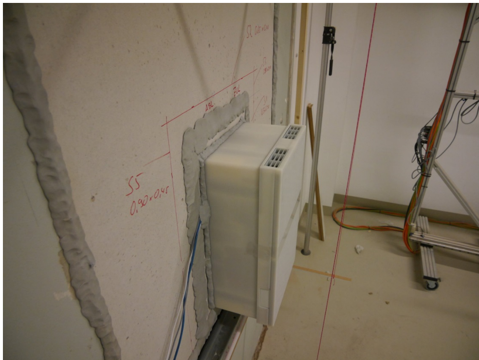
Abbildung B.8. Ansicht Lüftungsgerät innenseitig, prüffertig im Fensterprüfstand montiert und abgedichtet, Seitenansicht von schräg oben mit Lüftungsöffnungen (ABL vorne, ZUL hinten).
