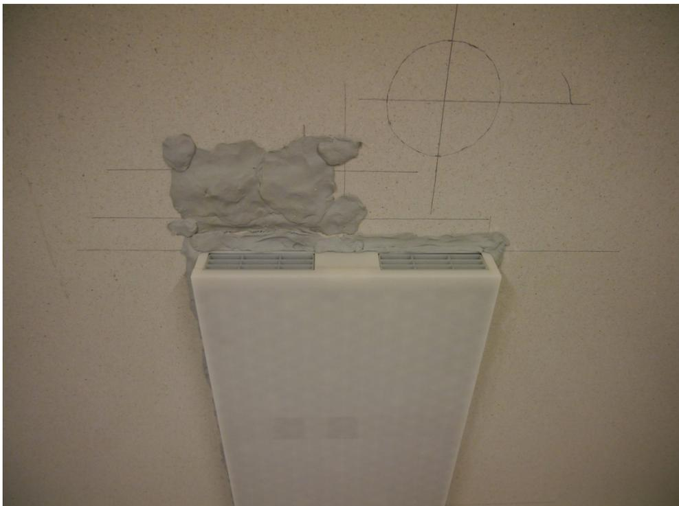
Abbildung D.12. UP-Einbau (Ein-Raum-Variante) prüffertig im Fensterprüfstand montiert und abgedichtet, Ansicht empfangsraumseitig von schräg oben mit Lüftungsöffnungen (ABL links, ZUL rechts).
