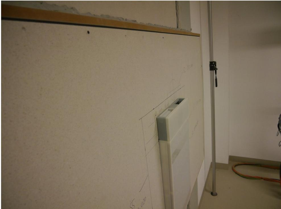
Abbildung D.17. UP-Einbau mit Kanalanschluss ABL-seitig prüffertig im Fensterprüfstand montiert und abgedichtet, Ansicht empfangsraumseitig von schräg oben.
