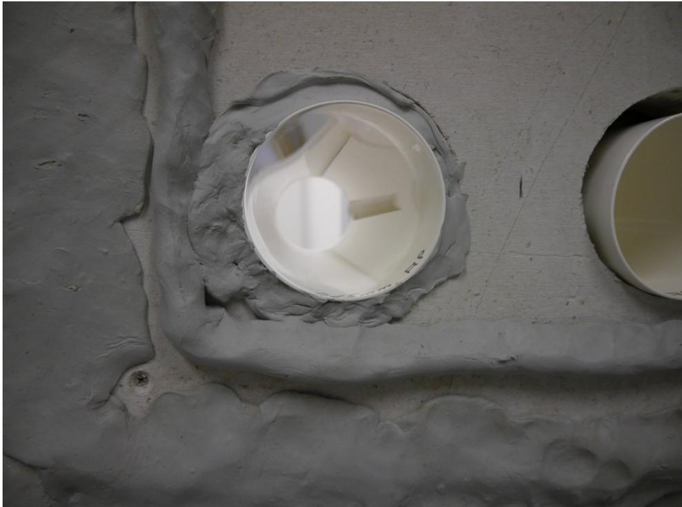
Abbildung D.3. Durchführung der Lüftungsrohre zu den Außenöffnungen durch die Trockenbaublende im Fensterprüfstand; links mit umlaufender Abdichtung, rechts noch ohne Abdichtung.
