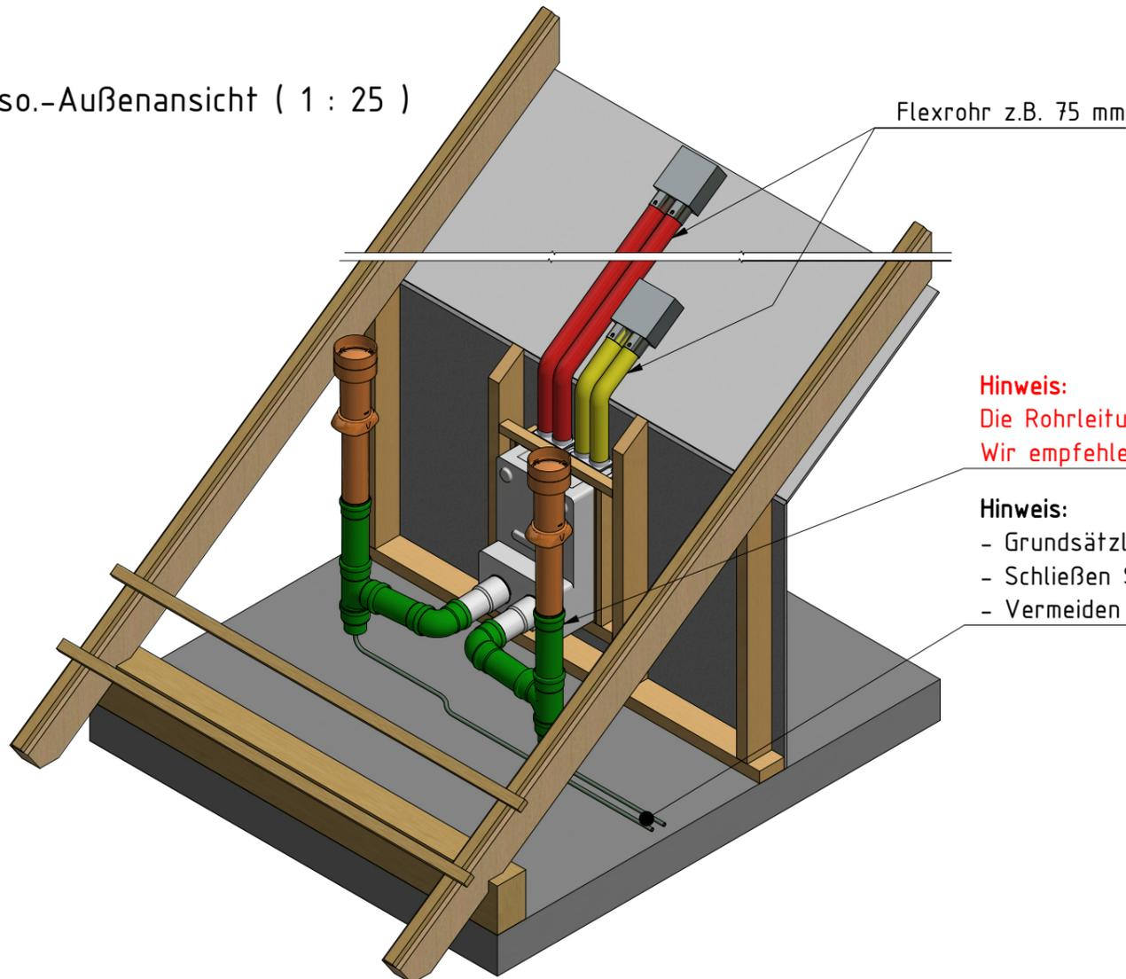
(1) Um einen Luftkurzschluss zu vermeiden, ist zwischen den beiden Dachhauben ein Mindestabstand von 0,8 m einzuhalten.
