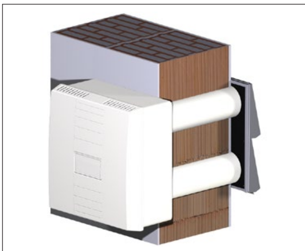
Obr. 1: Větrací jednotka - montáž na omítku
