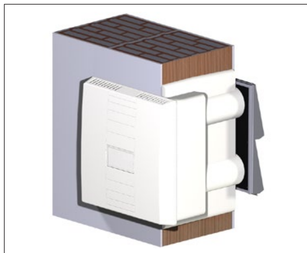
Obr. 2: Větrací jednotka - montáž pod omítku
